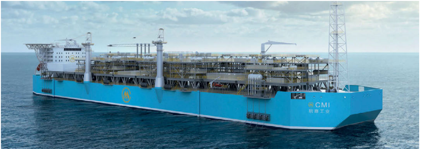
Das AiP für das FPSO-Design bestätigt die Machbarkeit eines robusten Rumpfs mit guter Ermüdungsbeständigkeit, der für den Einsatz an mehreren Feldstandorten optimiert ist
