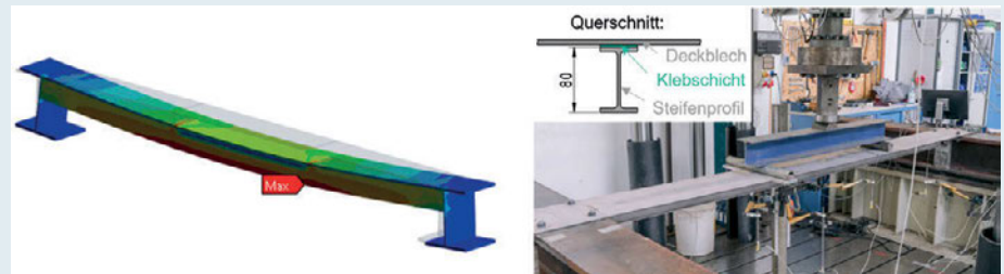
Abb. 3: Links: Entwicklung des Versuchsaufbaus auf Grundlage eines praktischen Anwendungsfalls mit Hilfe numerischer Modelle; rechts: Umsetzung der Berechnungsergebnisse in einem realen Versuchsaufbau zur Ermittlung der Biegetragfähigkeit klebtechnisch versteifter Plattenbauteile
