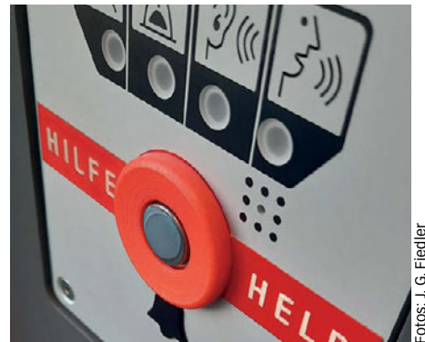
3D-Druck-Anwendungsbeispiele: Tastbare Handlauf-Beschilderung, Notrufknopf-Schutzring
