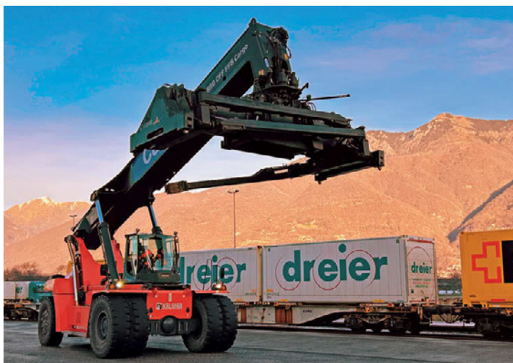
Ein von der SBB übernommener Reachstacker auf dem Terminal Cadenazzo
